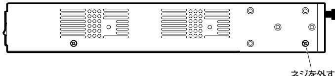
**3** プラケットを取り付けます。同梱のプラケット用ネジを使用して取り付けます。
