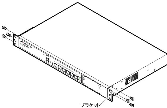
**4** ラックに付属のネジを使用して、19インチラックに本製品を取り付けます。
