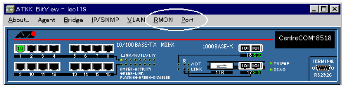
図 18.3.1 メニューバーの表示項目の増減（ポート選択により「RMON」と「Port」が出現）
