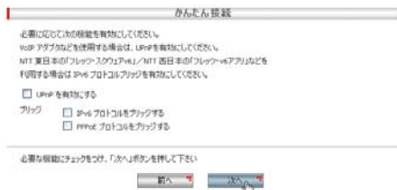
図 5.0.11 DHCP 接続で使用する機能
