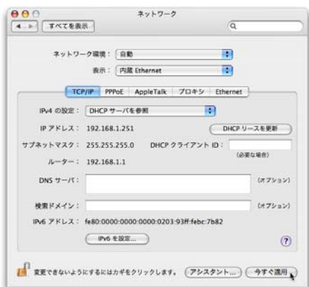
図 A.3.7 内蔵 Ethernet の設定
