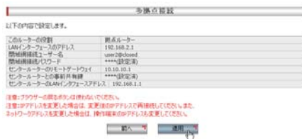
図 6.2.15 多拠点接続の確認 (拠点 B の場合)
