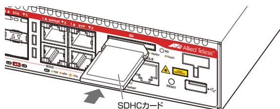
正しく装着されると、SDHCカードスロットLED（緑）が点灯します。
