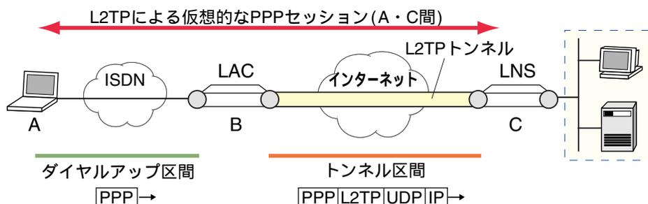
この構成では L2TP ルーターの役割が 2 つに分かれています。L2TP VPN サービスを提供する ISP は、LAC (L2TP Access Concentrator) と呼ばれる L2TP ルーターを用意します。LAC はユーザーからのダイヤルアップを受け付け、ユーザーから受け取ったデータ (フレーム) を本来の接続先である LNS に転送する中継ルーターです。図では B が LAC になります。
