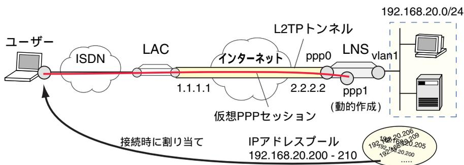
LNS は、L2TP トンネル経由で PPP ユーザーからの接続を受け入れるルーターです。ユーザーがトンネル経由で接続してくること以外は、通常のネットワークアクセスサーバーと同じ働きをします。
