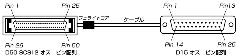
図 A.6.1 : V.24 (RS232) ケーブル、AMPLIMITE 50 ピン・コネクタ結線図
