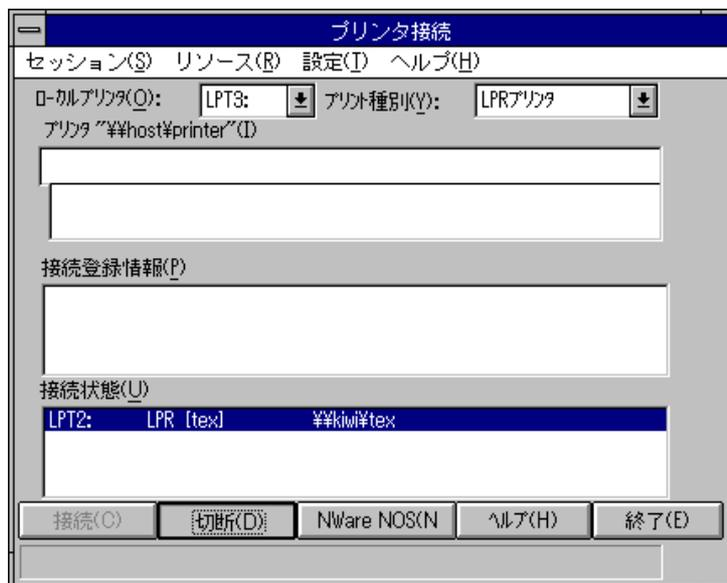
3. 仮想プリンタはアンマウント(接続解除)されます。「接続状態(U)」フィールドから消えます。
