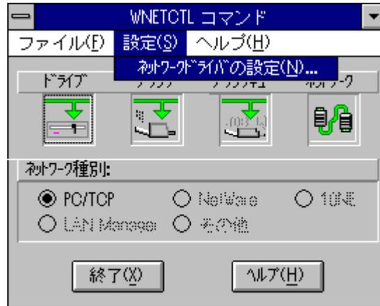
11. PC/TCP と共存させたいネットワーク OS を選択します。共存させたいネットワーク OS の機種名の「」をクリックし「x」マークを付けてから、「OK」ボタンを押してください。ここでは、「NetWare」を選択すると仮定します。
