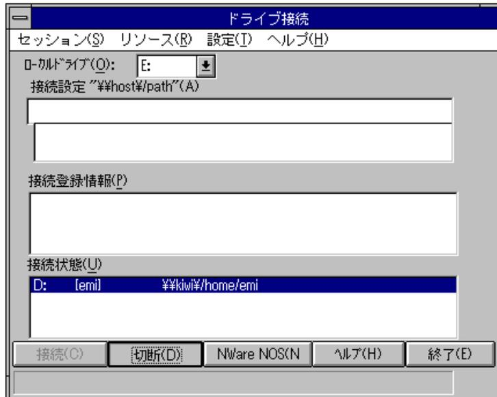
3. 仮想ドライブはアンマウント(接続解除)されます。「接続状態(U)」フィールドから消えます。
