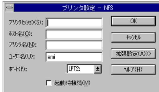
12. プリントセッション名、ホスト名、プリンタ名を入力し、「OK」ボタンを押します。ここでは、ホスト名 kiwi、プリンタ名 tex を仮定します。ユーザ名は、PC/TCP インストールのとき入力したユーザ名がデフォルトとして表示されます。ローカルプリンタデバイス (ローカルプリンタ) は、手順 1. ~ 8. で現在使用可能なものがデフォルトで表示されます。PC-98 シリーズの場合 LPT1:、DOS/V の場合 LPT1: ~ LPT3: が指定できます。
