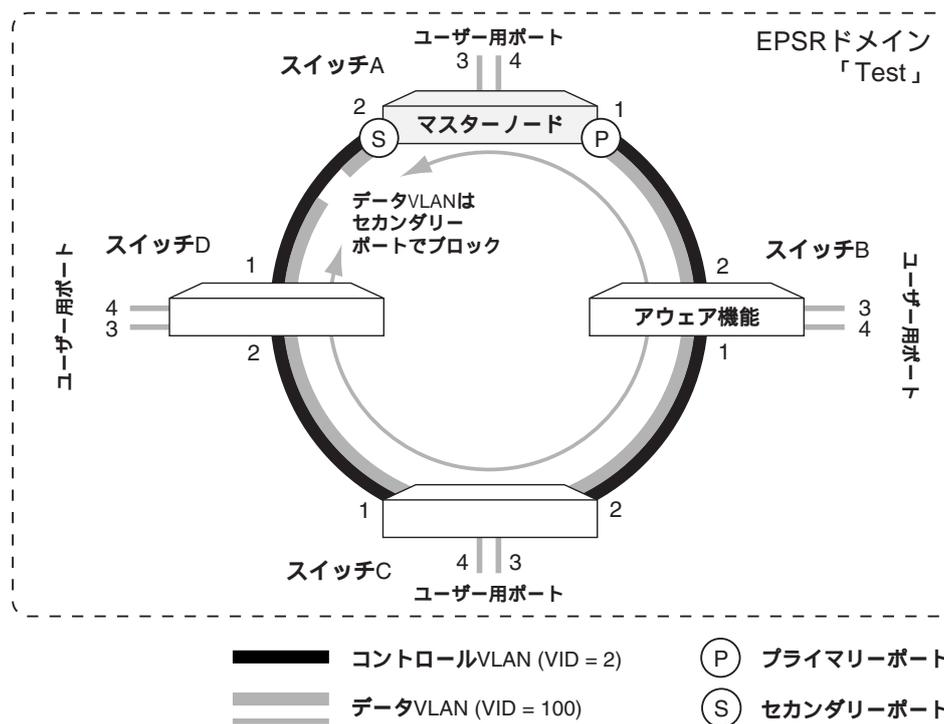
本製品はアウェア機能にのみ対応していますので、ここではスイッチ B の設定のみ説明します。マスターノードをはじめ、他のノードには、すでに同様の VLAN および EPSR ドメインの設定がされているものとします。
