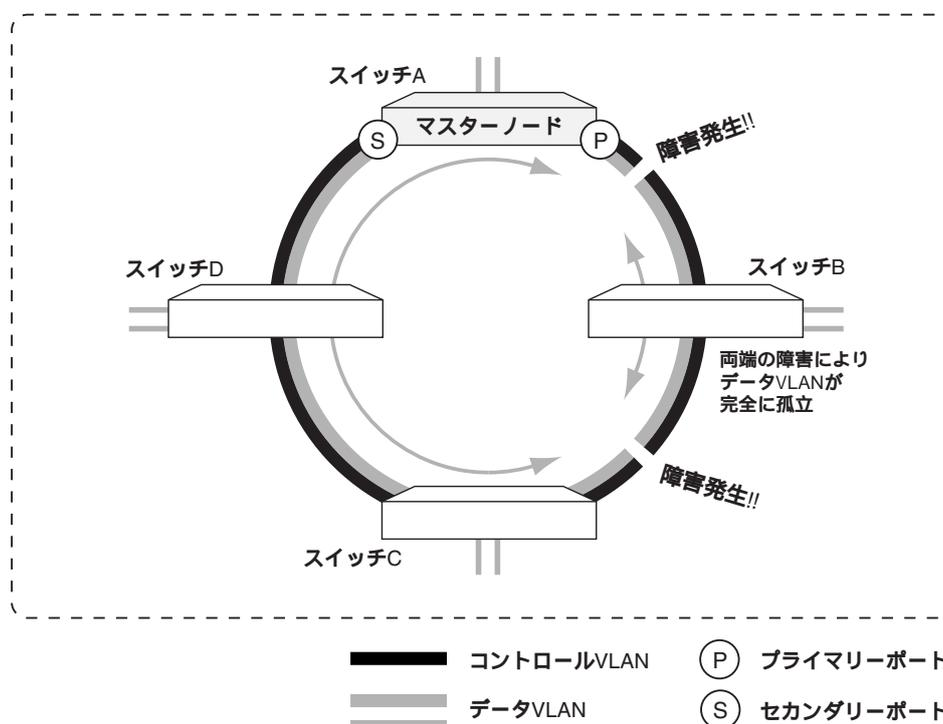
スイッチ C がフル実装のトランジットノードである場合、プリフォワーディング状態に遷移したポートは、上流 (マスターノードのプライマリーポートに近い側) のスイッチ B から Ring Up メッセージが届くまでの間、通信をブロックします。
