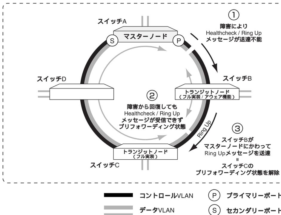
この問題を解決するため、スイッチ B は、片方のポートがリンクアップしてから 4 秒経過してももう一方のポートがリンクアップしない場合、マスターノードの代わりに Ring Up メッセージを送出してスイッチ C をフォワーディング状態に遷移させます。
