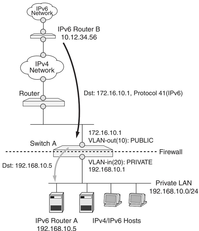
インターネット上にトンネルを張るには、トンネルの両エンドに互いに到達可能なグローバルアドレスが必要ですが、この環境ではルーター A にはグローバルアドレスがありません。そこで、プロトコル転送機能を利用して、スイッチの外部インターフェース ( 172.16.10.1 ) 宛てに届いた IPv6 over IPv4 トンネリングパケット ( IP プロトコル 41 ) を、内部ネットワークの IPv6 ルーター A に転送する設定を行います。これにより、ルーター B からはスイッチの外部インターフェースが、内部に存在するルーター A のインターフェースに見えます。
