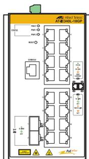
**注意** USBポート、コンソールポート、SFPスロット、10/100/1000BASE-Tポートにはご購入時にダストカバーが取り付けられています。ダストカバーは、各ポート/スロット使用時以外、はずさないようにしてください。
