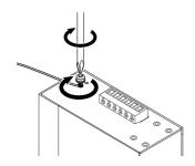
アース線のもう一方の端を、設置場所の適切な接地点に接続します。
