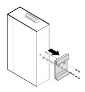
**3** 同梱のブラケット用ネジを使用して、本体天面および底面にブラケットを取り付けます。
