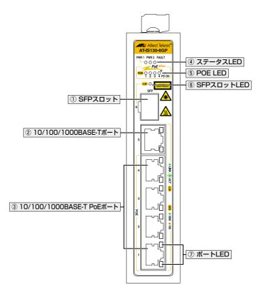
! すべてのポートおよびSFPスロットには、ご購入時にダストカバーが取り付けられています。 注意 ダストカバーは、各ポート/SFPスロット使用時以外、はずさないようにしてください。
