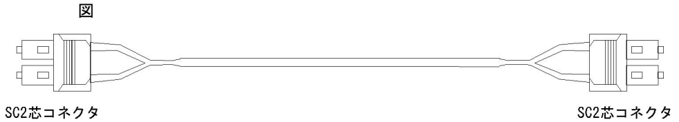
図 3-18 OC-192c POS 用シングルモード光ファイバケーブル（コア径 10\mu\text{m} ）の概略
