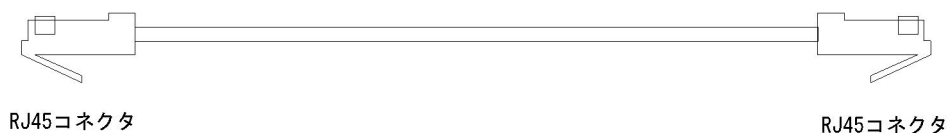
図 3-23 ツイストペアケーブル (ストレートケーブル) の概略図
