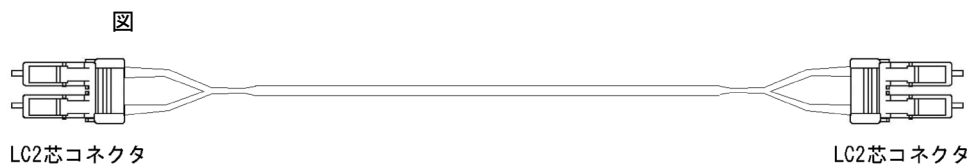
図 3-15 10GBASE-ER 用シングルモード光ファイバケーブル（コア径 10\mu\text{m} ）の概略
