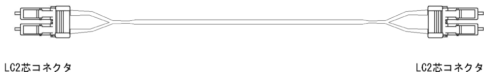
図 3-5 1000BASE-LH シングルモード光ファイバケーブル (コア径 8 \mu m) の概略図
