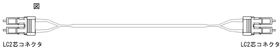
図 3-17 10GBASE-LR 用シングルモード光ファイバケーブル（コア径 10\mu\text{m} ）の概略
