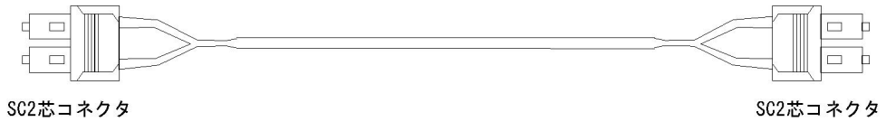
図 3-10 10GBASE-ER / 10GBASE-EW 用シングルモード光ファイバケーブル（コア径 10 \mu m）の概略図
