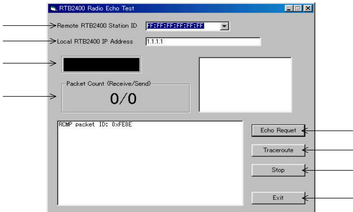
RTB2400 Radio Date Transfer Test : ある RTB2400 から電波を一定間隔で出し、他の RTB2400 でその電波が到達しているかをテストするテストツールです。
