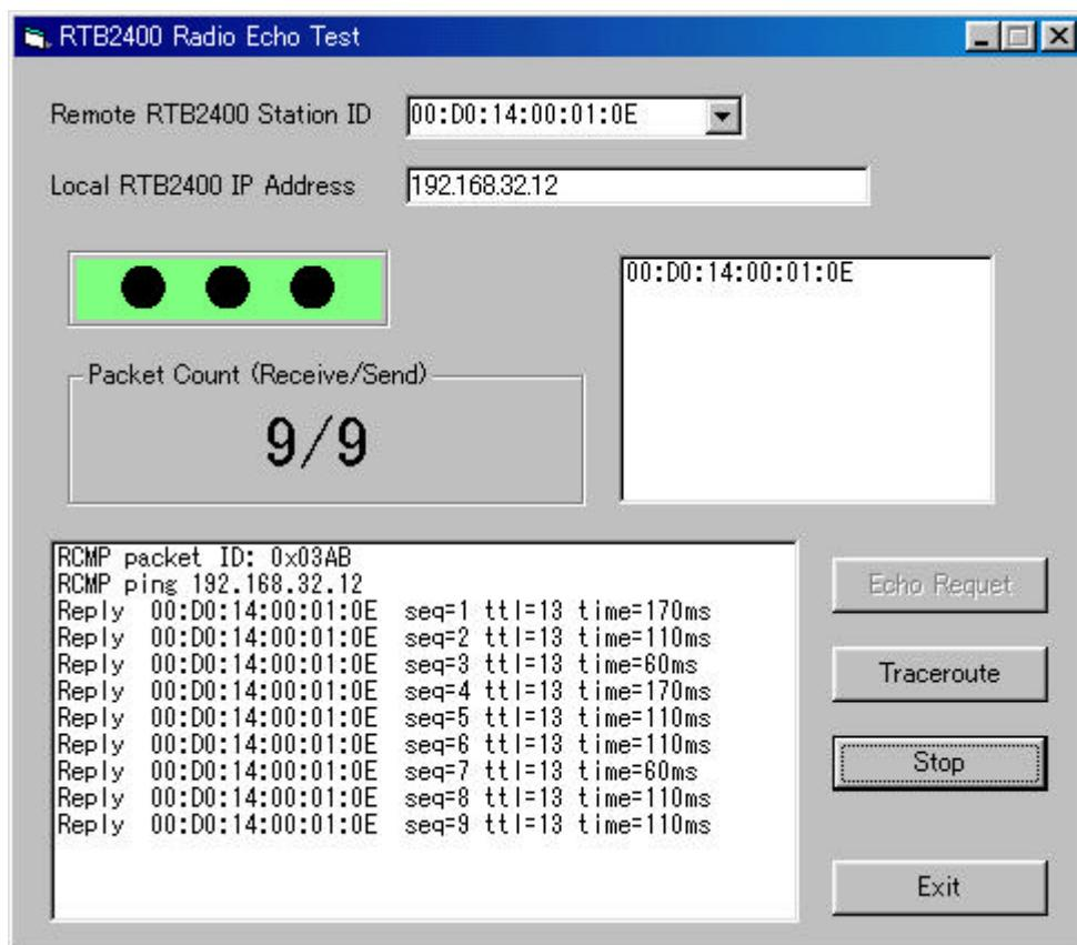
現地で通信確認(実際に電波が送受信できるかどうかの確認)を行う際に大変便利なモードです。1台のRTB2400からテスト用のパケットを任意の間隔(時間)で送信しつづけることが出来ます。また、パラメータファイルでRTB2400をテストモードに設定しますとRTB2400の電源をONにするだけでテストパケットの送信を始めます。
