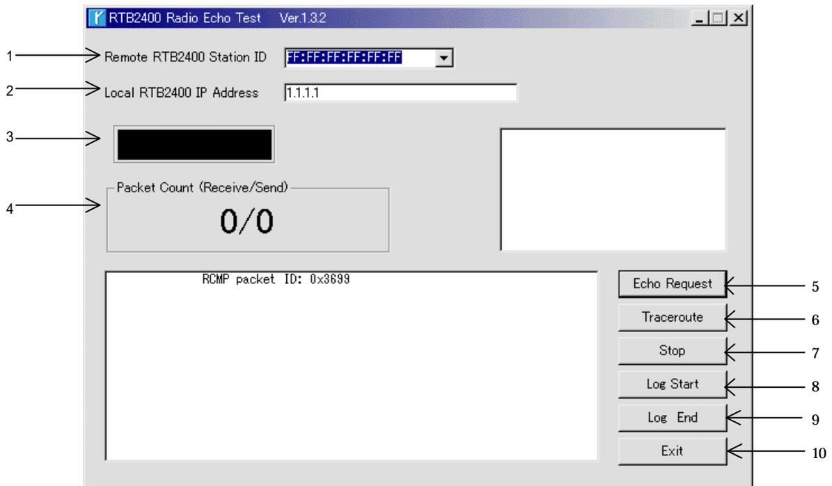
RTB2400 Radio Data Transfer Test : ある RTB2400 から電波を一定間隔で出し、他の RTB2400 でその電波が到達しているかをテストするテストツールです。
