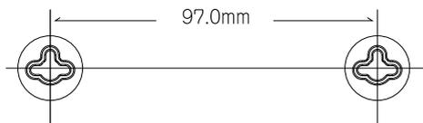
3 ネジ頭を 4.8mm ほど残して、ネジを壁にねじ込みます。
