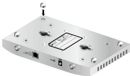
ゴム足は本体を固定し、衝撃を吸収するクッションの役目をします。本製品をデスクの上などに設置する場合は、必ずゴム足を使用してください。
