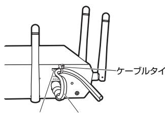
図 2.5.3 DC ケーブルの固定
