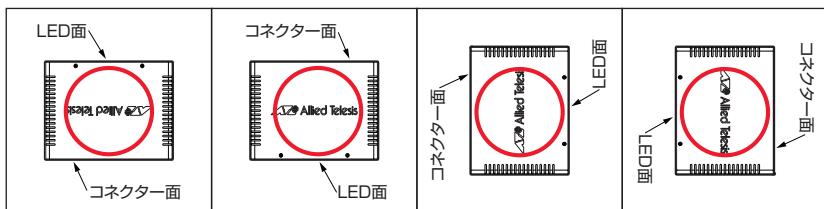
図 2.4.3 マグネットシートによる取り付け可能方向
