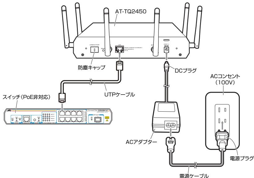
図 2.5.2 AC アダプターによる電源の供給
