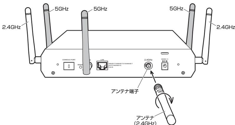
図 2.3.1 アンテナの取り付け
