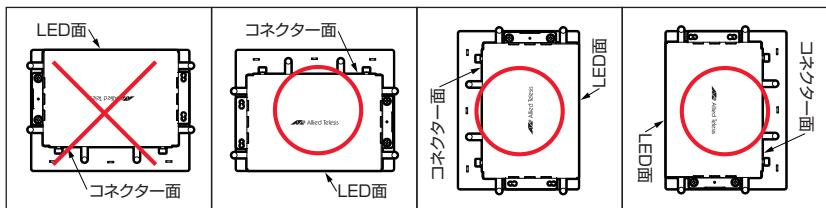
図 2.4.2 天井・壁設置ブラケットによる取り付け可能方向
