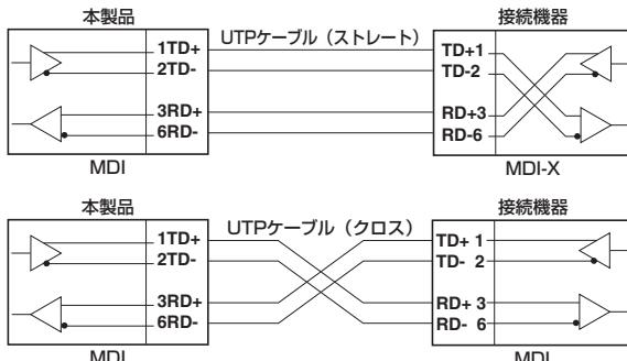
図 A.2.2 10BASE-T/100BASE-TX ケーブル結線図
