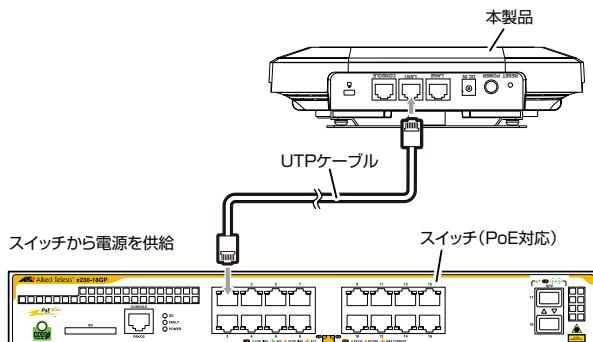
1 本体のLAN1/POEポートにUTPケーブルを接続します。スイッチのLANポートにUTPケーブルのもう一端を接続します。
