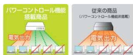
未使用ポートを自動判別し消費電力を制限することで省エネを実現します。スイッチングハブは通常、LANケーブルが接続されていないポートでも一定の電力を消費していました。本商品は、LANポートの接続状態を自動的に感知し、電力消費を必要な分だけに抑えて節約します。
