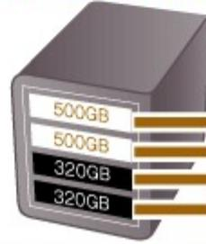
RAID1 ミラーリングペア x2 組の構成。それぞれのミラーリングペアでデータ保護性を確保します。図のようにそれぞれのミラーリングペアの容量が異なってもご利用いただけます。
