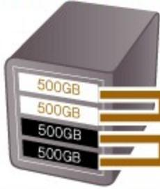
2 台を RAID1 でミラーリング、2 台を RAID0 でストライピングする構成です。RAID1 の 2 台ではデータ保護性を、RAID0 の 2 台ではアクセス速度と容量効率性を活かすことが可能です。
