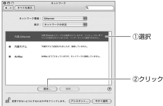
② 「IPv4 の設定」で、「DHCP サーバを参照」が選択されていることを確認します。
