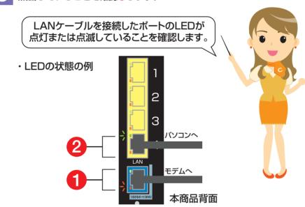
• LANの1~4ポートは、LANケーブルでパソコンと接続したポートのLEDの み点灯または点滅していることを確認20ます。 つながるポート(WANポート)のLEDが点灯・点滅しない場合は、次の内容を 確認してください。 LANケーブルがモデムと本商品にしっかりと接続されていること。 LANケーブルが断線していないこと。
