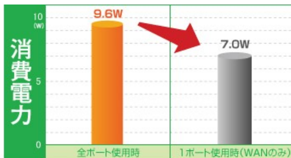
※全ポート動作時と1ポート(WANのみ)使用時の消費電力を比較。
